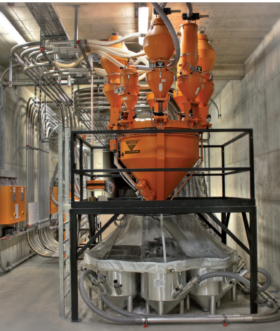
Graviko, il sistema di dosaggio gravimetrico a otto componenti di Koch Technik
