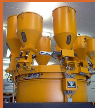
Fig. 4 - Sistema gravimetrico Koch con dosaggio multimateriale e miscelazione
